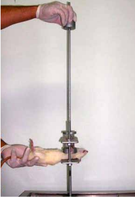
Şekil 1. Yüksekten ağırlık düşürme yöntemi için kullandığımız düzenek. Anestezi sonrasında sıçan metal tabla üzerine yatırıldıktan sonra göğüs kısmı üzerine başka bir metal serbest silindir tabla yerleştirilmekte ve 500 mg ağırlığında metal silindir 50 cm yüksekten göğüs üzerine düşürülmektedir. İşlem her sıçana bir kez uygulanmaktadır.
